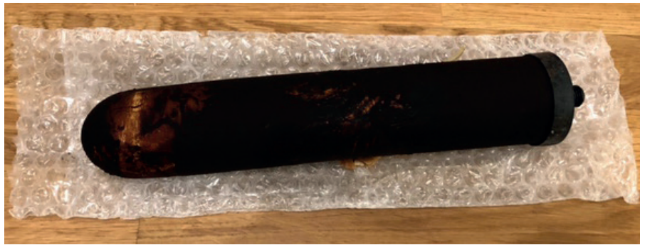
4. ÁBRA: Erősen szennyezett vízsűrő betét az ivóvízhálózatból [11]
