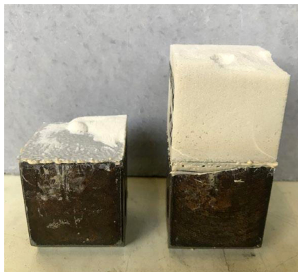
3. ÁBRA: Poliuretánhab minta nem megfelelő szakadási képe (fotó: BMN)
