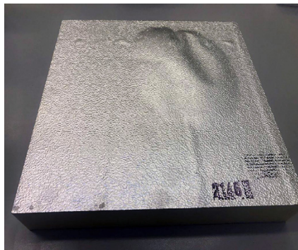
5. ÁBRA: A kasírozóanyag felhólyagosodása az egyik poliuretánhab mintán (fotó: BMN)
