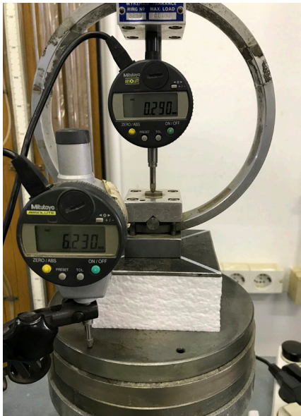
1. ÁBRA: EPS minta összenyomódási viselkedésének vizsgálata (fotó: BMN)
