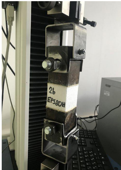
2. ÁBRA: EPS minta húzószilárdsági vizsgálata (fotó: BMN)
