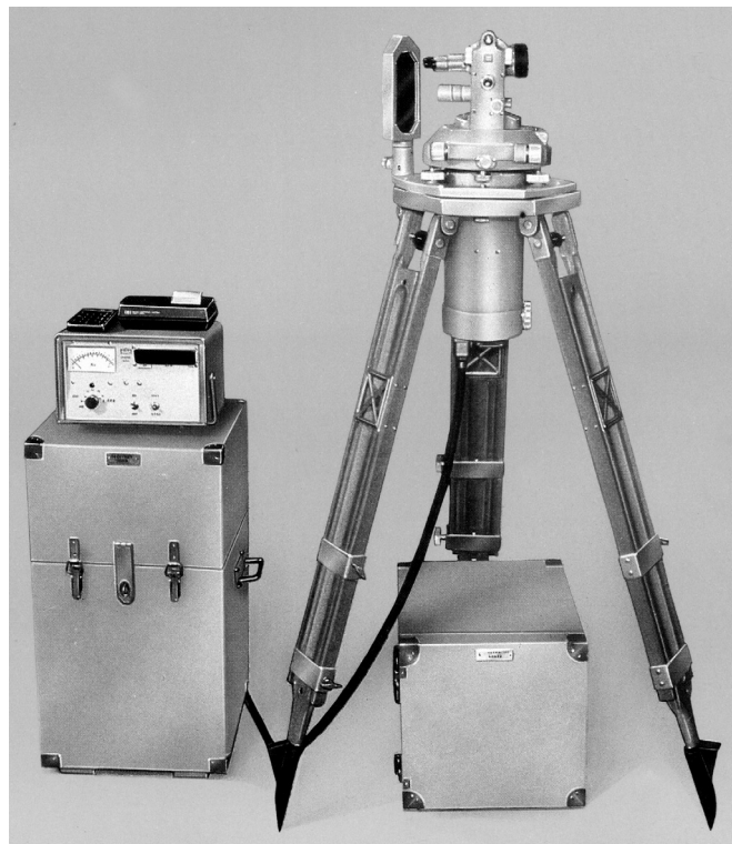
6. ÁBRA: A Gi-B11 giroteodolit és tartozékai (a Magyar Optikai Művek Emlékalapítvány archívumából)
