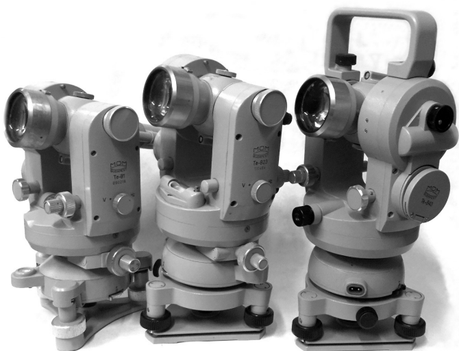
4. ÁBRA: A Bors Károly által tervezett Te-B1 másodpercteodolit és továbbfejlesztett változatai, a Te-B23 és a Te-B43 a Magyar Optikai Művek Emlékalapítvány gyűjteményében (AA)
